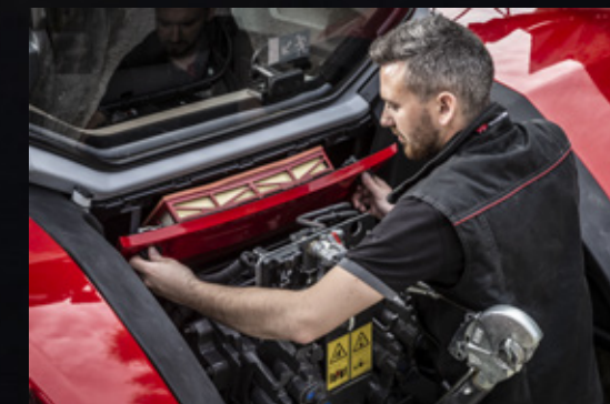
Let adgang til kabinefilter for rengøring.
