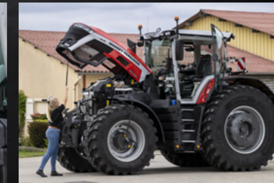
Forakslen og udformningen af motorhjelmens gør det let at få adgang til olieind og -filter
