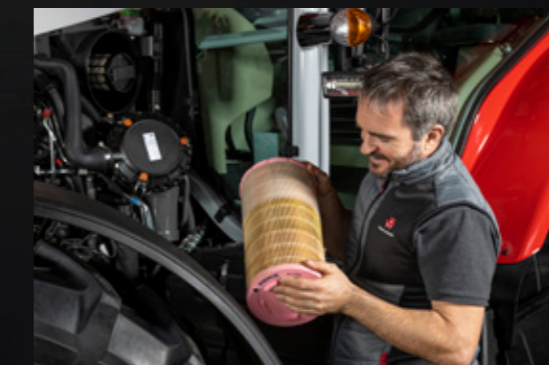
Motorens luftfilter er let tilgængeligt og let at rengøre.
