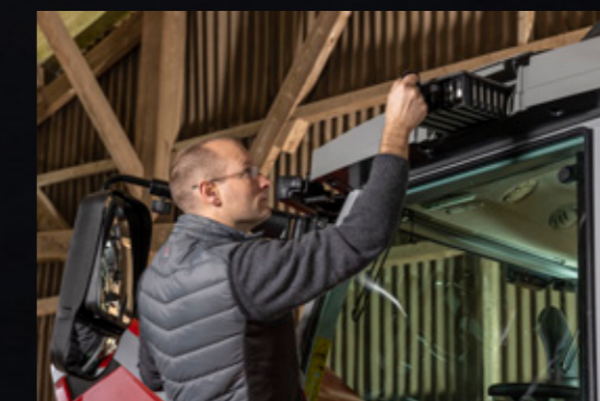
Let adgang til kabinefilter for rengøring.
