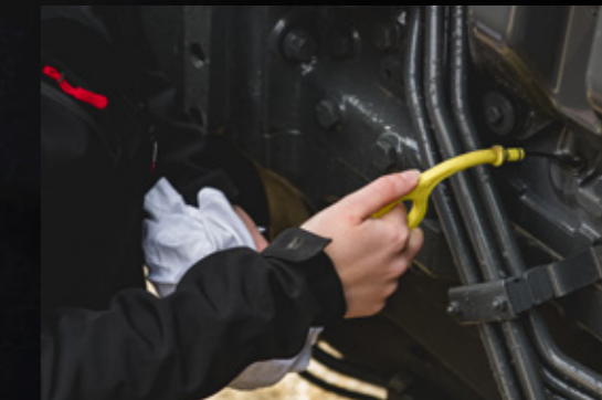
Forakslens og udformningen af motorhjælmen gør det let at få adgang til olieind og -filter.
