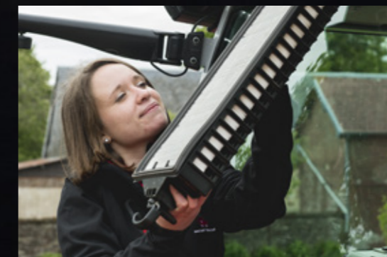
Let adgang til afmontering af kabinefilter for rengøring.
