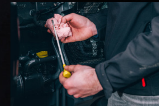
Forakslen og udformningen af motorhjelmen gør det let at få adgang til olieind og -filter.
