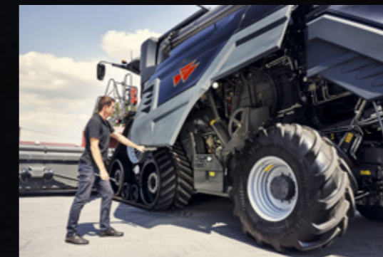
Helstøbte paneler med lys giver hurtig og praktisk adgang til eftersyn
