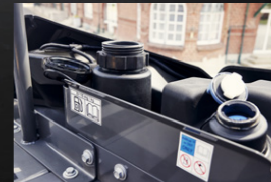
Nem påfyldning – diesel- og AdBlue-tankpåfyldning er placeret ved siden af hinanden, så der er nem adgang
