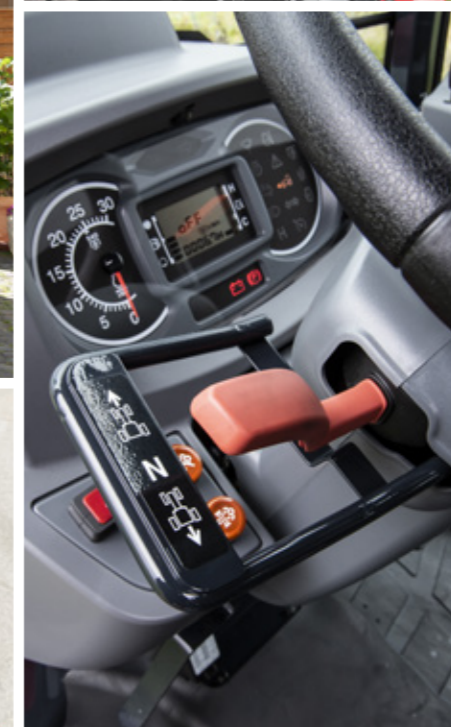
El-hydraulisk styrearm til power shuttle på MF 1700 M modellerne giver større komfort
