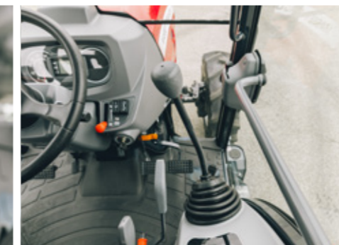
Mere komfort med vipbar ratstamme og hydraulisk joystick i højre side til nem og nøjagtig styring af redskaber
