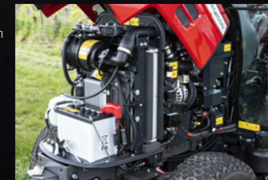
Udformning af motorhjelme og foraksel sikrer nem adgang til motoren.
