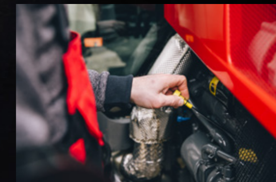
Forakslen og udformningen af motorhjelmen gør det let at få adgang til olieplade og -filter.
