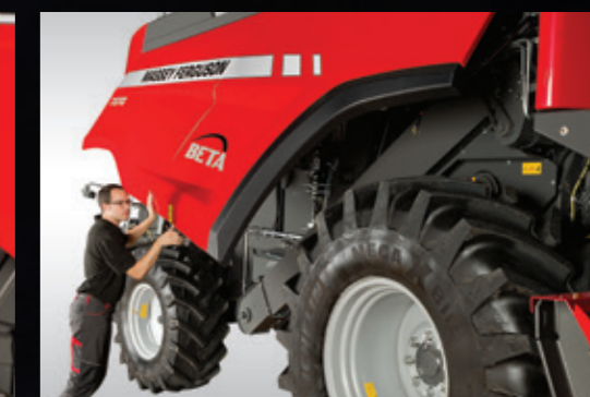
Helstøbte paneler med lamper giver hurtig adgang ved eftersyn
